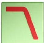
Der [DON](#) wird bei 60 Hz angekoppelt und bekommt noch eine Tiefbassanhebung bei 25 Hz. Man braucht einen separaten Verstärker für die Subwoofer!
