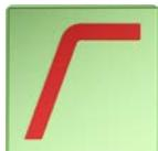
Für den Hochtöner wird ein Hochpassfilter verwendet. In diesem Beispiel wird 1.400 Hz als Übernahmefrequenz eingestellt. Der Kalottenhochtöner wird mit einem Filter 1. Ordnung (6 dB / Oktave) angekoppelt.
