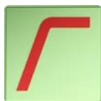
Die Satelliten werden mit einem Hochpassfilter von tiefen Tönen befreit. Kleine Satelliten kann man bei 100 Hz trennen. Dann sollten aber die Subwoofer in der Nähe stehen. Erst ab 80 Hz kann man den Subwoofer nicht mehr orten. Also wenn es die Größe der Satelliten erlaubt, immer unter 100 Hz trennen.
