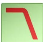
Die Mitteltöner werden mit einem Hochpass- und einem Tiefpassfilter beschaltet. Diese Kombination aus zwei Filtern wird auch Bandpassfilter genannt. Dieser Filter 2. Ordnung (12 dB / Oktave) arbeitet zwischen 200 Hz und 2.100 Hz.
