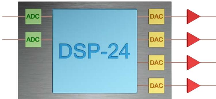
digitales Signal um. Der Digital-Signal-Prozessor (blau) verarbeitet die Daten nach den eingestellten Konfigurationen. Diese Konfigurationen können aus Pegelanpassungen, Frequenzübergängen und parametrischen Equalizer-Einstellungen bestehen und beliebig kombiniert werden. Der Digital-Analog-Konverter (gelb) wandelt die bearbeiteten digitalen Signale aus dem DSP in analoge Signale und diese Signale werden anschließend an die externen Verstärker (rot) weitergeleitet.
