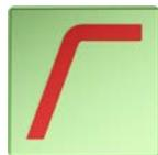
Die Satelliten werden mit einem Hochpassfilter von tiefen Tönen entlastet. Es werden meist 12 dB Filter bei 80 Hz bis 100 Hz verwendet.
