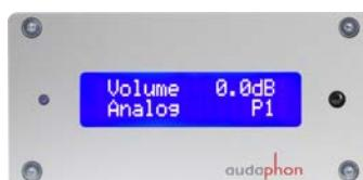
Das Display ist mit einem Empfänger für die Fernbedienung ausgestattet. Somit ist es empfehlenswert die Bedieneinheit auf die Front vom Lautsprecher bzw. Subwoofer zu bauen.
