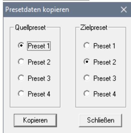
Presets sind Klang- und Frequenzweicheneinstellungen die mit einem Taster auf der Rückseite vom AMP-24 gewechselt werden können. Die Presets kann man ohne PC im laufenden Betrieb wechseln. Vier LEDs zeigen das aktuell eingestellte Preset. Presets kann man mit der Kopierfunktion bearbeiten. Unter dem Menüpunkt „Bearbeiten“ finden Sie den Eintrag „Preset kopieren...“. Es erscheint ein Fenster mit
