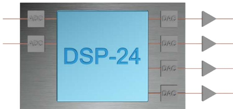
Ein DSP ist ein Mikrocomputer, dessen interne Architektur für die schnellstmögliche Verarbeitung von digitalen Signalen optimiert ist. Der DSP bekommt vom ADC die digitalisierten Audiosignale. Diese Signale können mit spezifischen Filtern versehen werden. Die Eingänge können den Ausgängen individuell zugewiesen werden, diesen Vorgang nennt man
