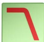
Der Mittel-Tief-Töner wird mit einem Tiefpassfilter beschaltet. Dieser Filter 1. Ordnung (6 dB / Oktave) arbeitet mit einer Trennfrequenz von 1.400 Hz.
