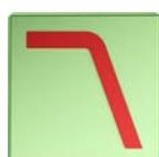
Der Subwoofer wird mit einem Tiefpassfilter von den hohen Tönen befreit. Auch der Tiefpassfilter arbeiten bei 80 Hz bis 100 Hz.
