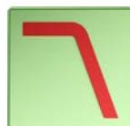
Der Tieftöner bekommt einen Bandpassfilter 2. Ordnung (12 dB / Oktave). Die Übernahmefrequenzen liegen bei 200 Hz und 60 Hz. Man braucht einen separaten Verstärker für die Woofer!
